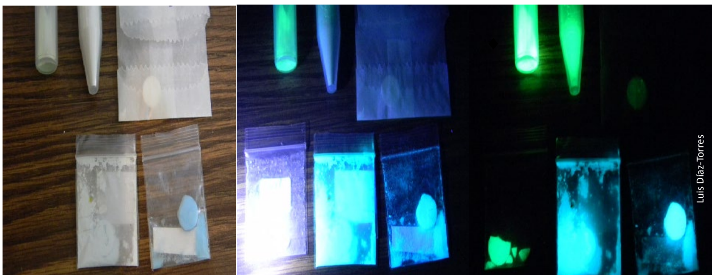
Fig. 1, Materiales fosforescentes bajo iluminación de luz blanca, y en la oscuridad al cesar la iluminación de luz blanca.
