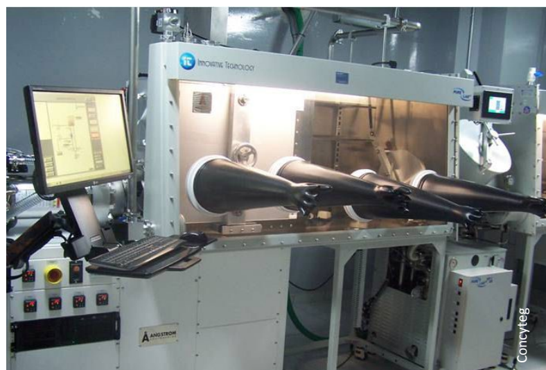
Sistema de Depósito de Películas Delgadas + Cajas de Guantes con atmósfera controlada. GPOM-CIO.
