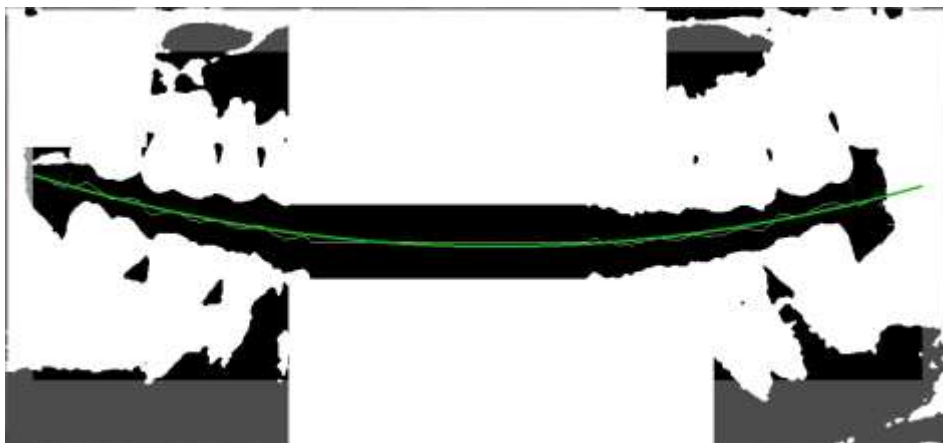
Figura 12. - Ajuste de esqueleto con polinomio cuadrático mediante mínimos cuadrados
