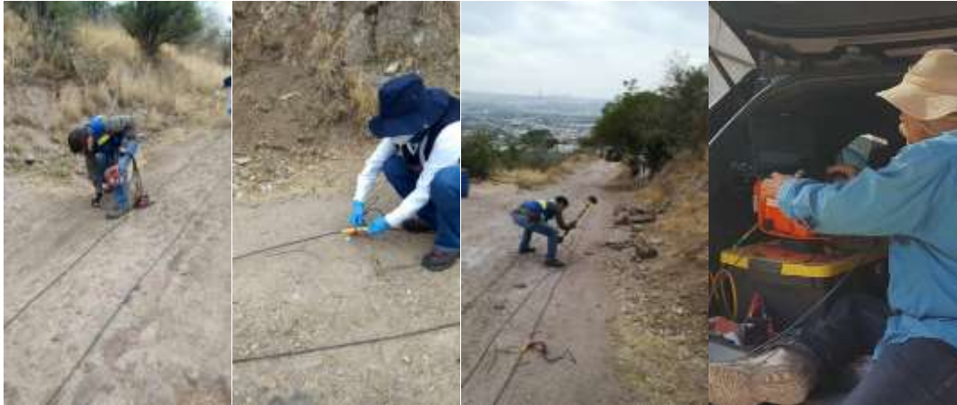
Figura 8. Conexión de geófonos sobre la línea de tendido sísmico y generación de ondas sísmicas.
