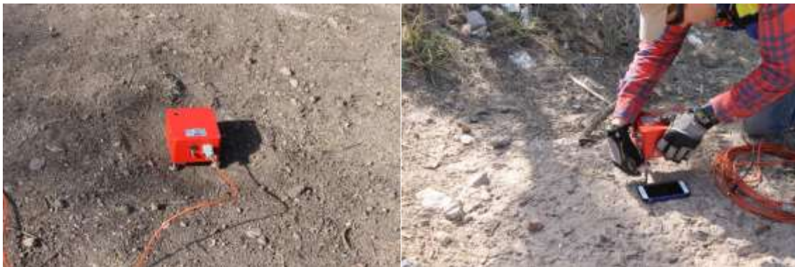
Figura 7. Sismómetro triaxial, utilizado para el levantamiento geofísico por fuente pasiva.
