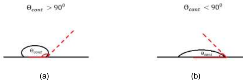
Figura 1 a) El líquido no moja la superficie, b) el líquido moja la superficie.
