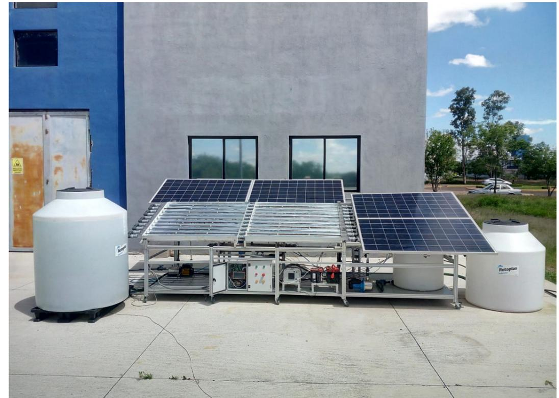
Figura 1.- Sistema potabilizador autónomo impulsado por energía solar, el cual será evaluado en su rendimiento [3].
