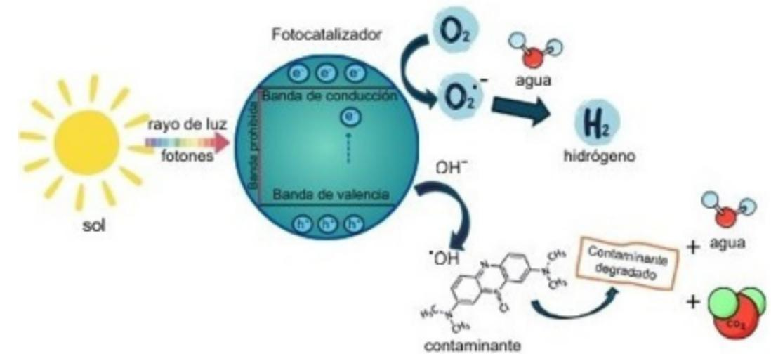
Fig. 1. Mecanismo del proceso de destrucción de contaminantes mediante el proceso de oxidación avanzada fotocatalítica.
