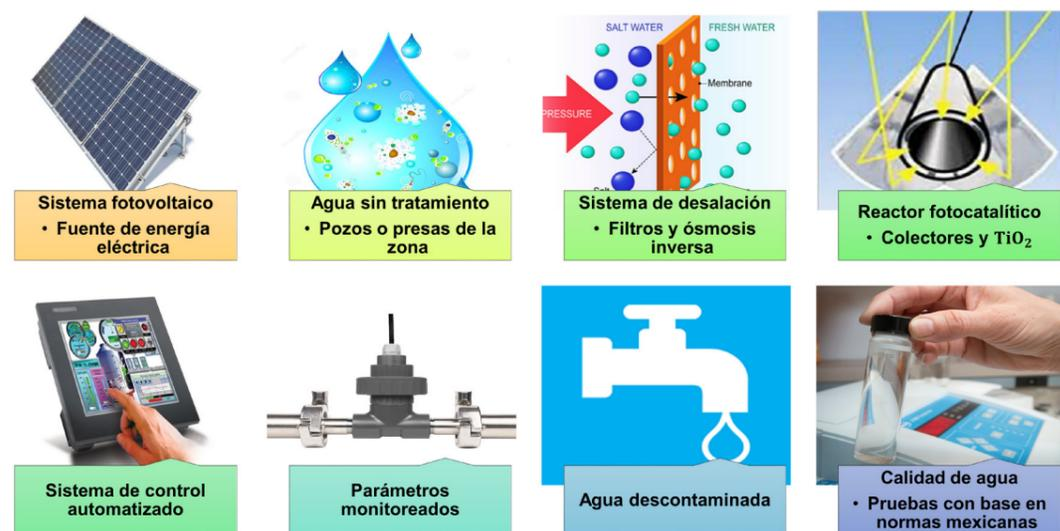
Figura 2.- Etapas de las que consta el potabilizador para obtener agua de calidad acorde a las normas mexicanas.
