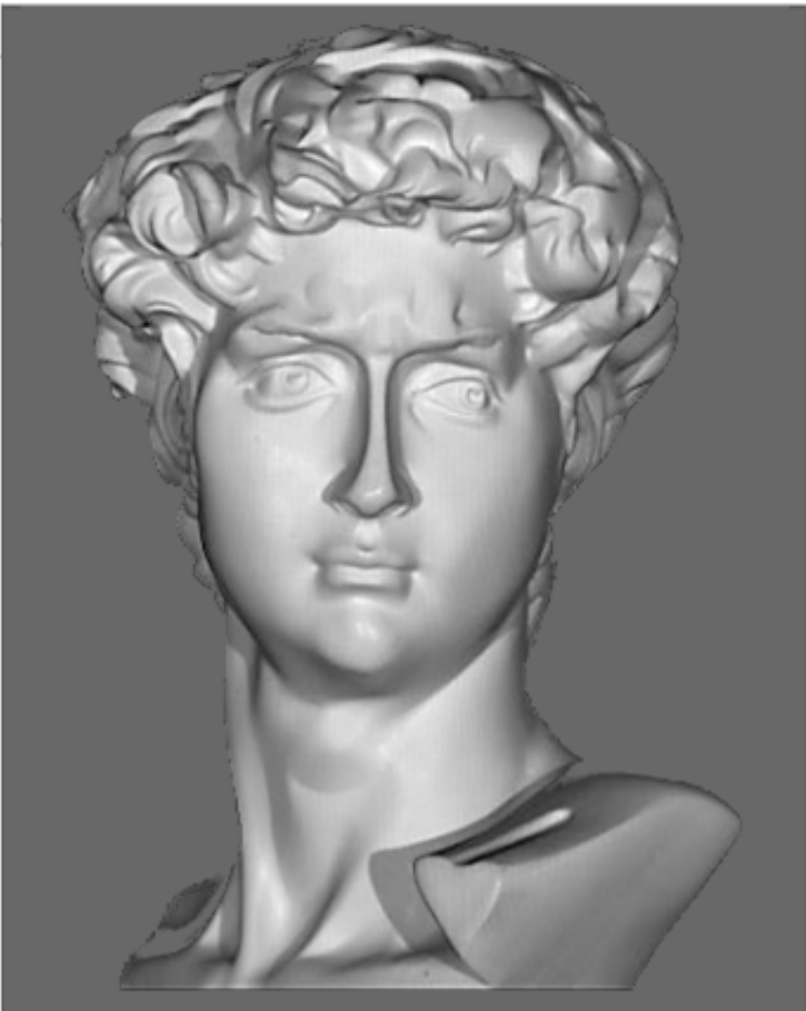
Figura 3. Imagen de la reconstrucción tridimensional del busto de “El David” usando la invención. Observe que la digitalización es 3D completa (sin huecos por sombras) y sin ruido (fidelidad y nitidez de la digitalización).
