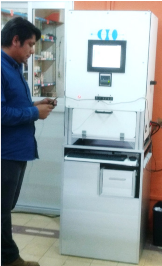
Figura 2. Máquina de visión artificial para definir y medir perímetros de plantillas.
