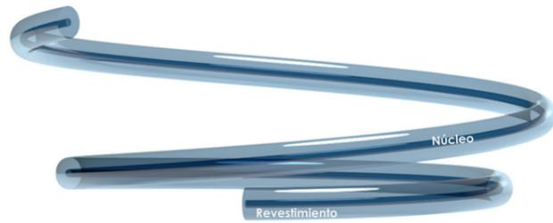
Figura 2. Representación de una fibra óptica convencional.
