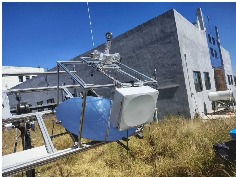
Figura 1. Dispositivo de concentración solar del CIO Unidad Aguascalientes, para aplicaciones de alta temperatura (vista frontal).
