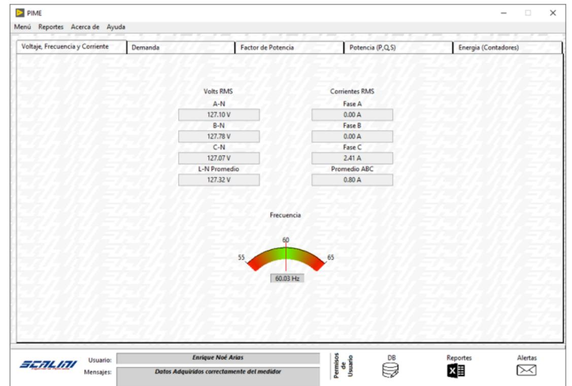
Imagen 2: Pantalla principal de PIME midiendo algunos parámetros eléctricos de la acometida del laboratorio de Soluciones en Ingeniería.
