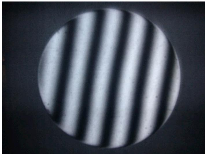
Figura 1. Interferograma correspondiente a la evaluación de una superficie plana
