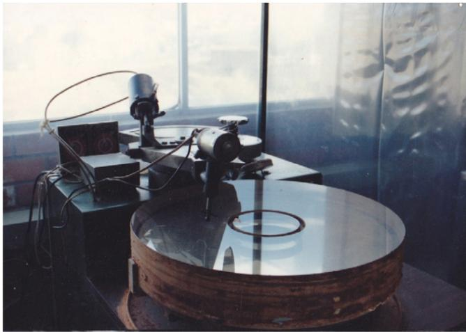
4. Uno de los espejos primarios de 620 mm para telescopio Cassegrain RC, fabricado en los talleres del CIO.
