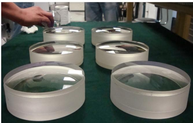
7. Lentes tripletes para espectrómetro en proceso de cementado óptico, fabricadas en el taller óptico del CIO.
