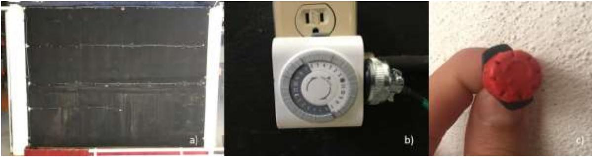
Figura 3. a) Sistema de riego, b) Temporizador usado para control de riego, c) Válvulas utilizadas para el control de riego por goteo.
