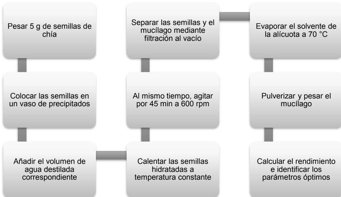
Figura 5. Diagrama de flujo del proceso de extracción de mucílago de chíá.
