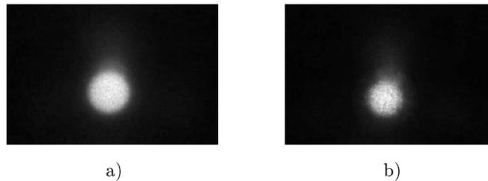
Figura 3. Imágenes adquiridas de la salida de luz de las fibras multi-modo analizadas con el sistema de medición, (a) HCF-250-47 y (b) MM-S200/220-22A.
