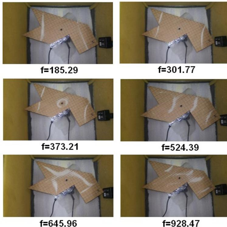
Figura 2. Patrones de Chladni para la placa 1; las frecuencias están en Hz.
