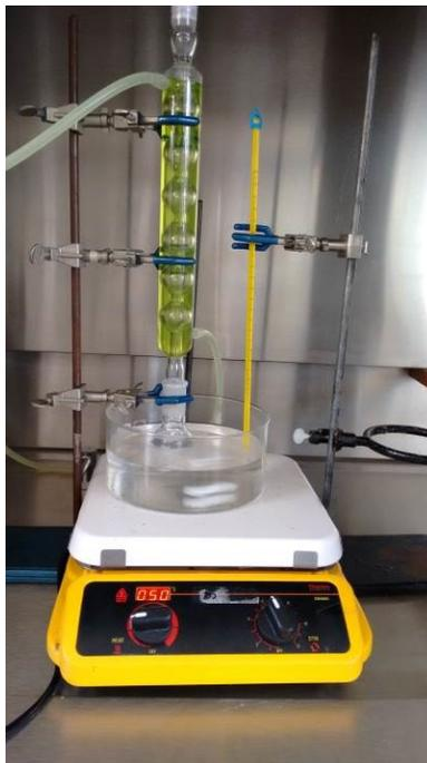
Figura 5.-Dispositivo experimental de síntesis por el método poliol
