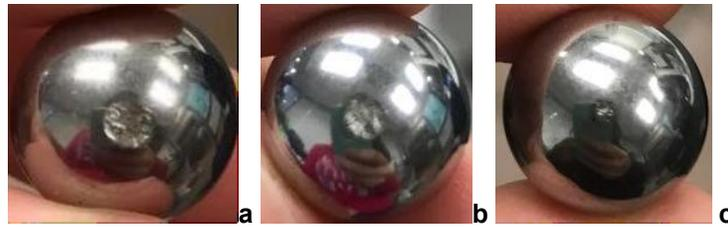
**Figura 7.** Tamaño de desgaste en la superficie de los balines: a) aplicación agua destilada; b) MWCNT con grupos  $-COOH$ ; c) Nanoestructuras de carbono de 3D nanotori<sup>TM</sup> (NTC).
