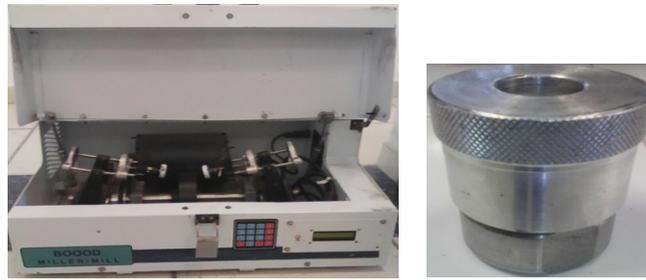
Figura 1. Molino de bolas marca SPEX 8000D de alta energía y contenedor.
