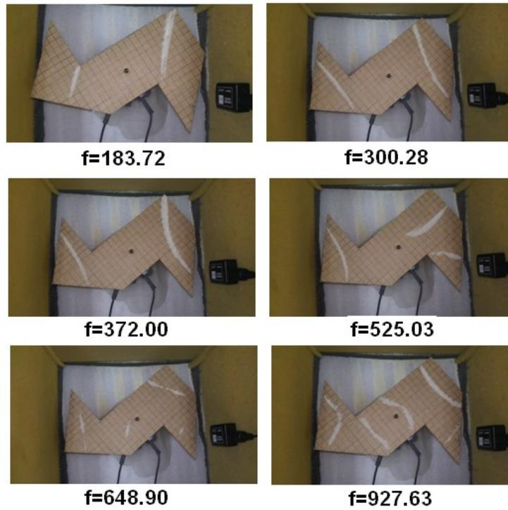
Figura 3. Patrones de Chladni para la placa 2; las frecuencias están en Hz.
