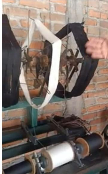
Figura 3. Enrollado del hilo en las coneras
