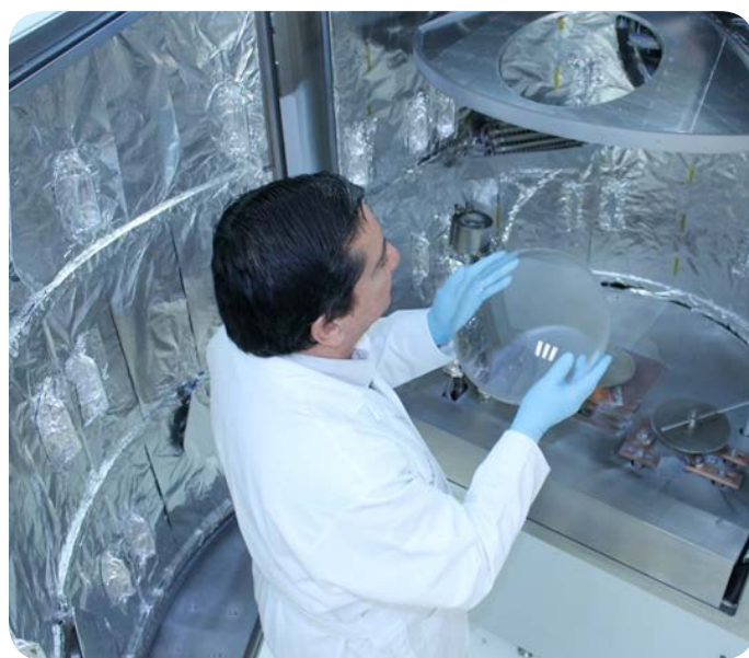
Imagen 2. Evaporadora Denton Integrity para el depósito de películas delgadas, con un domo de 39 pulgadas de diámetro.
