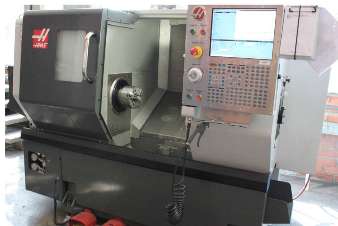
Torno CNC de la marca HASS ya instalado en el taller opto mecánico.
