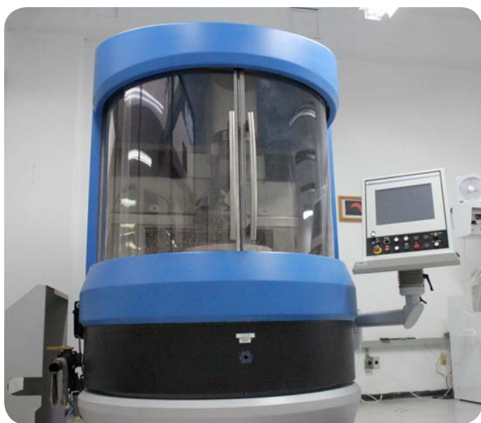
Imagen 1. Pulidora de control numérico por computadora Zeeko IRP 400, con capacidad para pulir ópticas hasta de 400 mm de diámetro. IRP son las siglas de Intelligent Robotic Polisher .
