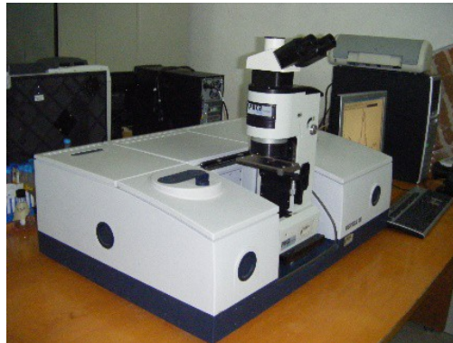
Figura 1. Espectrometro FTIR, modelo vertex 70
