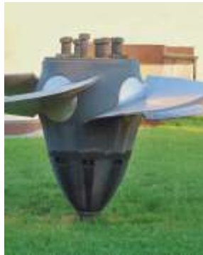
Figura 2. Turbina Kaplan fuente. https://www.enelgreenpower.com/es
