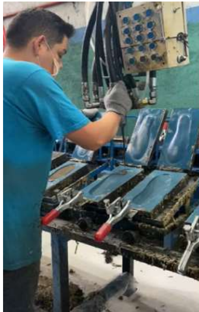
Figura 2. Proceso de fabricación de plantilla de poliuretano
