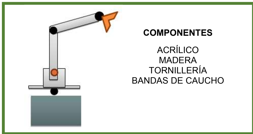
Figura 6.- Esquema y materiales de robot cilíndrico a construir.
