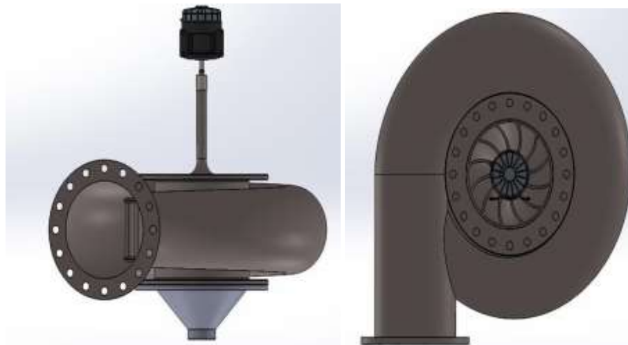
Figura 5. Ensamble terminado del motor y la turbina incluye salida de Caudal
