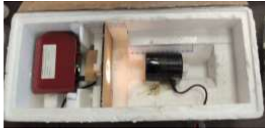
Figura 4 Arreglo experimental para la medición espectroscópica de los pigmentos mediante el uso de un espectrómetro, cubo rectangular de cuarzo y lámpara de tungsteno halógeno.
