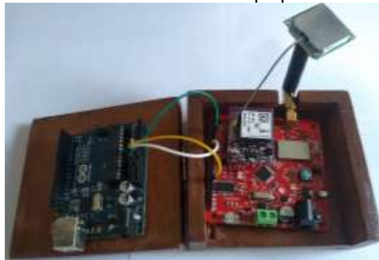
Figura 2. Prototipo generado con módulo GPS con antena y Arduino
