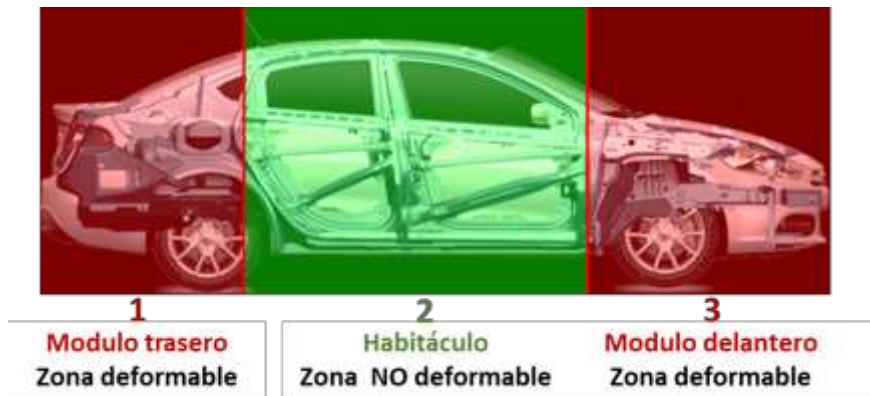
Figura 2. Zonas de seguridad del chasis de un automóvil.
