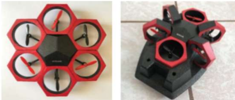
Figura 5. Configuración del HA: a).modo de operación aéreo y b).modo de operación terrestre/acuático.
