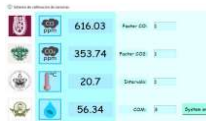
Figura 3. Interfaz gráfica editada en Python para visualizar las lecturas de humedad, temperatura y la concentración en ppm de CO 2 .
