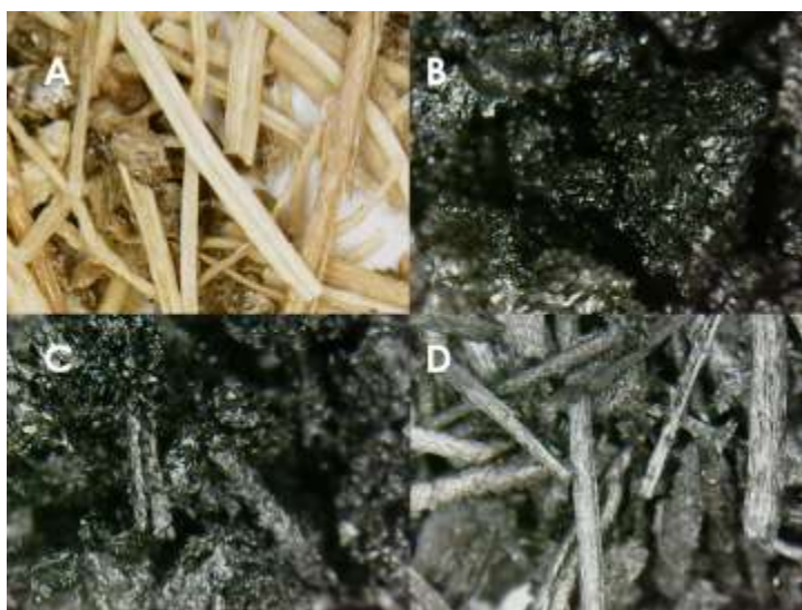
Figura 50 Fotografía del bagazo de agave (A), carbón de bagazo de agave porosidad alta (B), media (C), baja (D)
