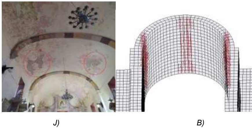
Figura 19. A) Daño observado en el prototipo del TSJD. B) Daño observado en el modelo numérico (Autoría propia)
