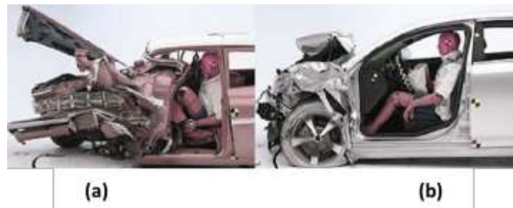
Figura 1. Comparación de la evolución del chasis en dos vehículos. (a) vehículo antiguo, (b) vehículo nuevo.
