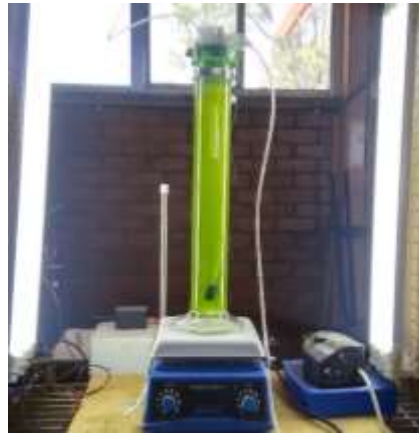
Fig. 59. Fotobiorreactor tubular en operación (fotografía de autoría propia).
