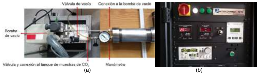
Figura 2. a) Montaje de la prueba de hermeticidad. b) Equipo de control de la bomba de vacío.
