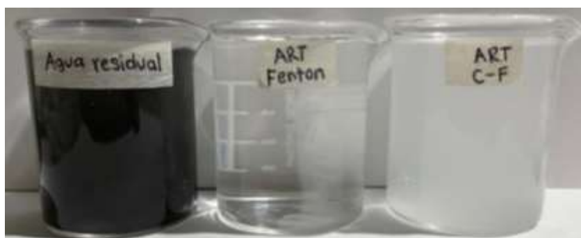
Figura 102. Aspecto visual del ARI en comparación con el ART por Fenton y el ART por coagulación-floculación.
