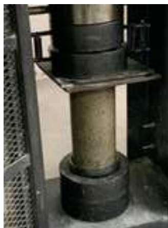
Figura 5. Colocado de cilindro ensayo Prensa Hidráulica.
