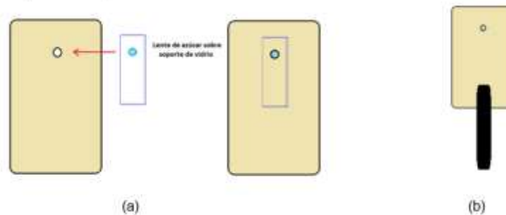
Figura 6. a) Colocación de la lente de azúcar entre las dos láminas de cartón perforadas, b) microscopio simple terminado.
