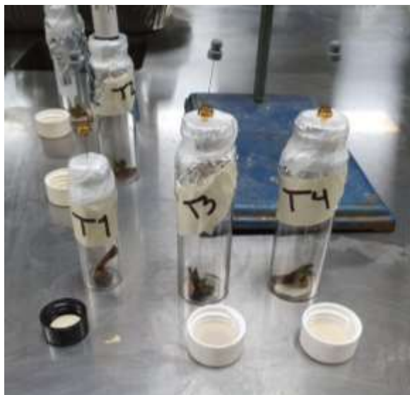
Figura 3. Sistema de extracción de COVs.
