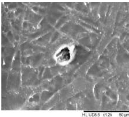
Figura 12. Morfología de la superficie del PU por microscopía electrónica de barrido (SEM). PU a 35 días de contacto con Rhizopus spp.
