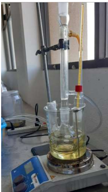
Figura 2. Equipo utilizado para la reacción de transesterificación.
