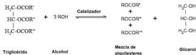
Figura 1. Ruta general de la reacción de transesterificación de un triglicérido.
