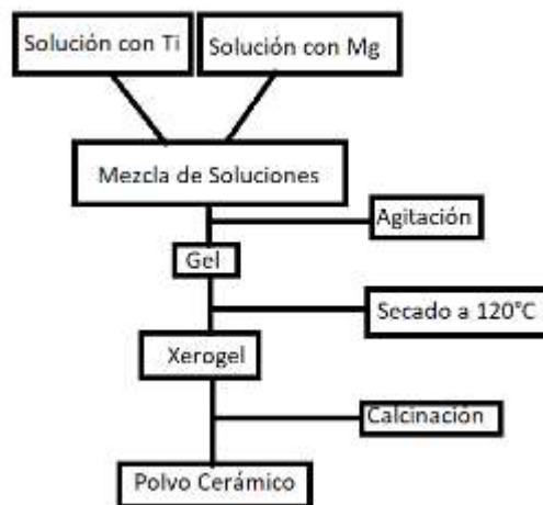
Figura 2. Diagrama de Flujo para mezcla de los elementos óxidos de los catalizadores
