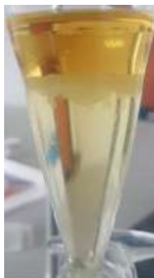
Figura 3. Muestra de biodiesel, fase superior y glicerol, fase inferior.
