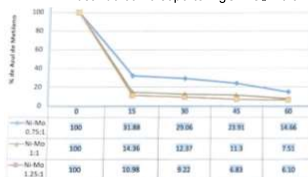
Gráfica 2. Porcentaje de conversión del ADM sobre tiempo usando las 3 concentraciones distintas de Ni/Mo usando como soporte MgO/TiO 2 = 0.5
