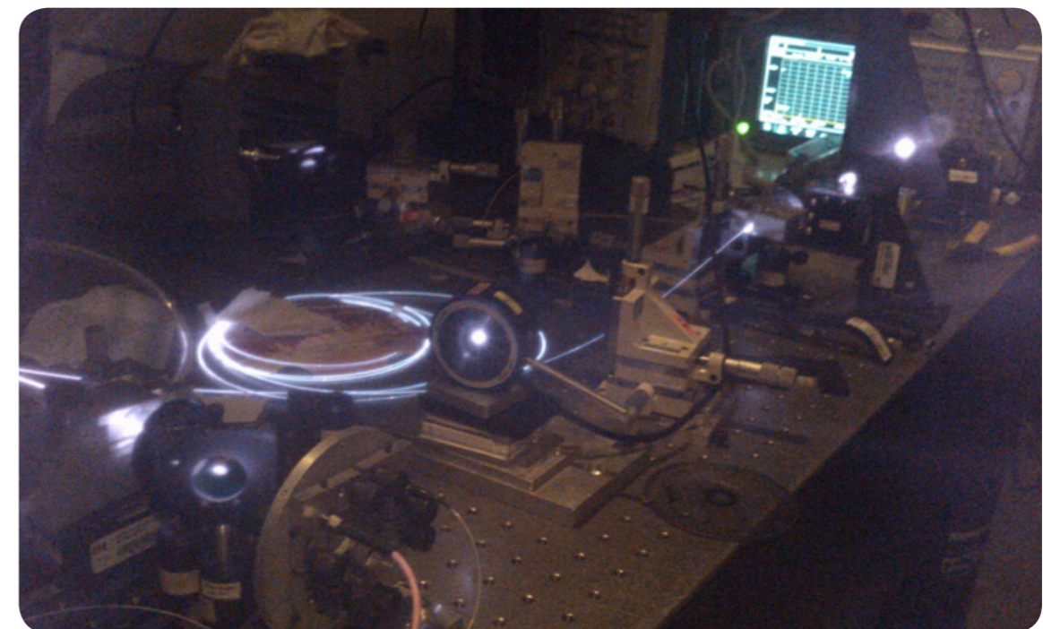
Láser de fibra óptica de doble revestimiento operando en modo pulsado implementado en el laboratorio de fibras ópticas del CIO.
