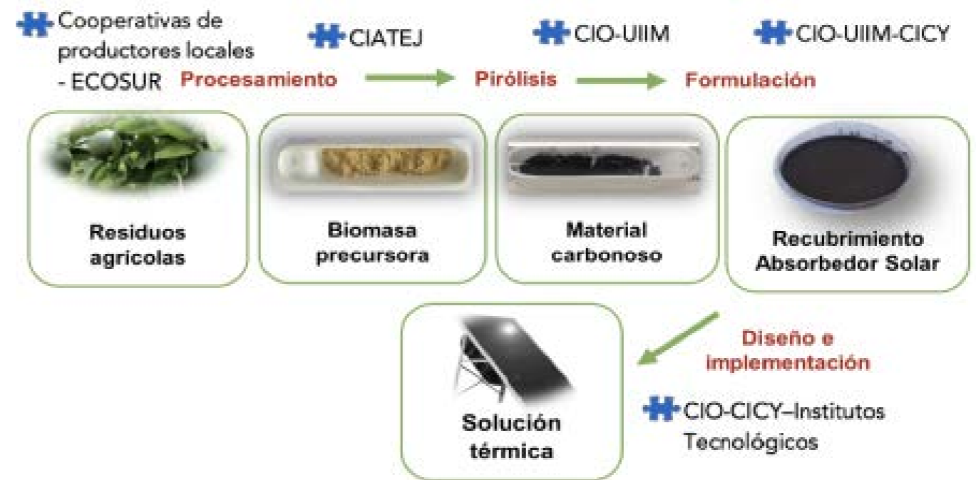
Figura 3. Cadena de proceso de obtención de soluciones térmicas a partir de recubrimientos absorbentes solares basados en biomasa de desecho
