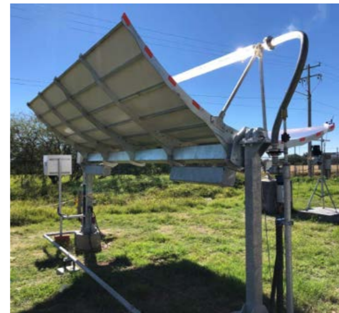
Concentrador desarrollado por la empresa Inventive Power® con apoyo del GIIE-Sol
