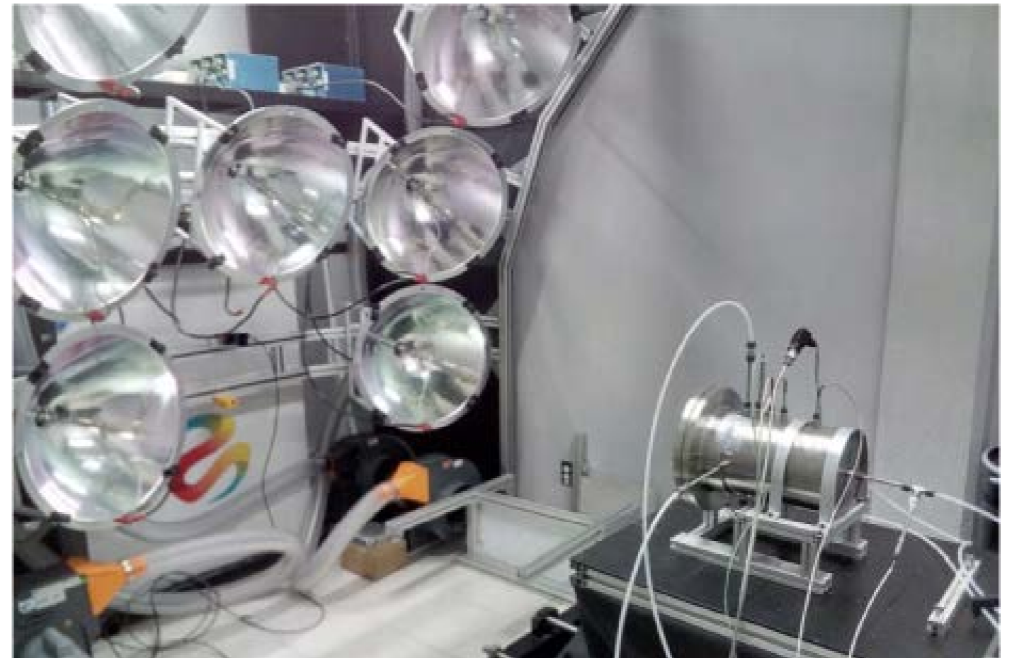
Figura 1. Simulador Solar de Alto Flujo Radiativo (SSAFR) desarrollado por el CIO - Unidad Aguascalientes.
