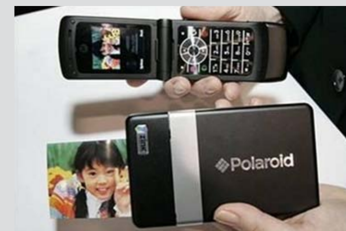
Impresora Polaroid con tecnología Zink. Se conecta a teléfonos inteligentes o a cámaras digitales a través de puertos USB 2.0 o de la tecnología inalámbrica Bluetooth.
