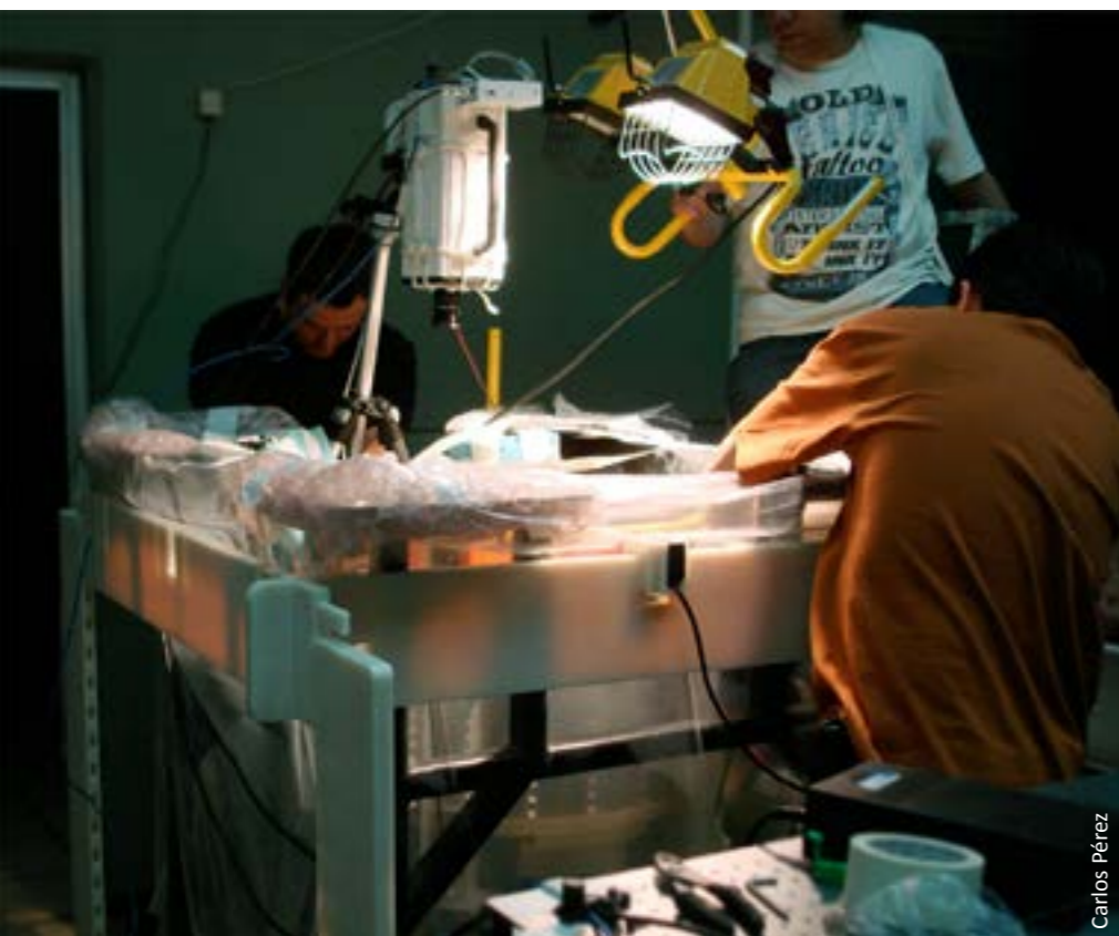
Inspección de una tina de lavadora en rotación con una cámara rápida (1000 cuadros/seg).
