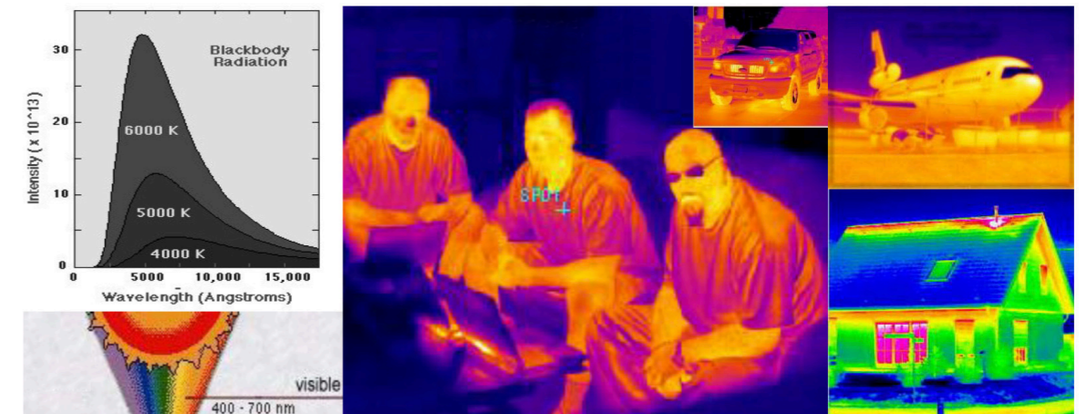
Fig. 8. La temperatura superficial del sol se estima a 6000 K, la de nuestro cuerpo está alrededor de 300 K (23 C), y la de la lámpara incandescente 3000 K. Así el sol emite blanco-amarillo, la lámpara amarillo muy intenso, y nuestros cuerpos sólo la radiación infrarroja. Nos vestimos para impedir la pérdida de calor, y complacer a quienes nos ven.
