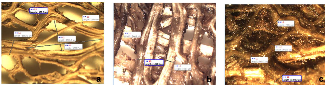
Fig. 5 a) Fibra natural. b) Material compuesto con 2 capas. c) Material compuesto con 3 capas.
