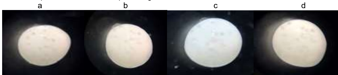
Figura 5. a) microcápsula con 1 h de curado, b) microcápsula con 2 h de curado, c) microcápsula con 3 h de curado y d) microcápsula con 4 h de curado.
