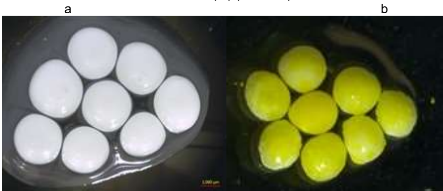
Figura 7. Microcápsulas con 4 horas de curado a) MC en medio HCl 0.1 M (2.43 mm) b) MC en medio Au(III) (2.39mm).
