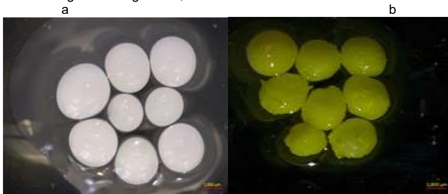
Figura 6. Microcápsulas con 1 hora de curado a) MC en medio HCl 0.1 M (2.43 mm) b) MC en medio Au(III) (2.12mm).
