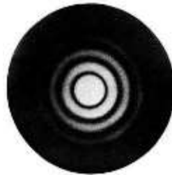
Fig. 2 Sección transversal del patrón de difracción de una abertura circular
