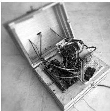
Figura 1. Primera sección de la estación climatológica en la que se observa la tarjeta Arduino, el contador Geiger, la pantalla LCD y el módulo de la tarjeta SD.
