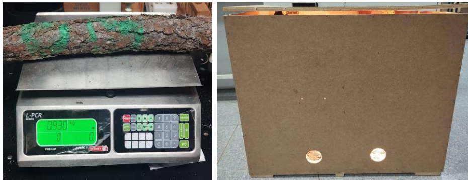
Figura 4. Pesaje de una muestra de rama en fresco para su posterior proceso de secado
