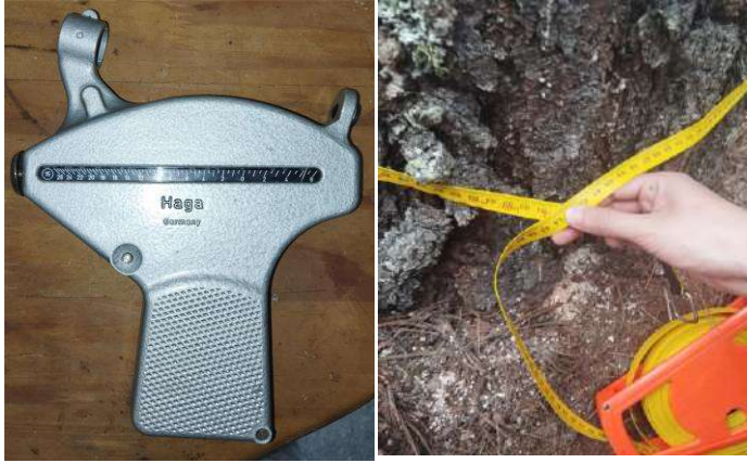
Figura 3. Pistola HAGA (Altímetro) para la medición de altura y cinta diamétrica para la medición de perímetros.
