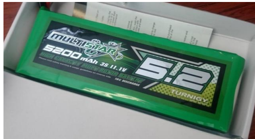
d) Pila de tres celdas
