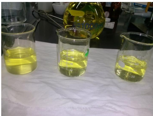
Figura 3.5 Soluciones de Cromo (VI) antes y después de agregar carbón pirolítico para su posterior titulación.
