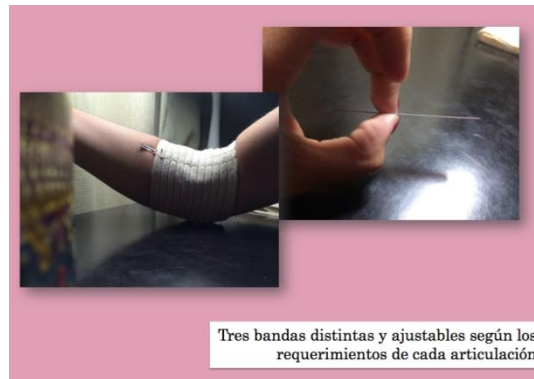
Fig. 3 Goniómetro electromecánico ergonómico diseñado en base al FlexSensor de Spectra Symbols. Se muestra colocado en el codo únicamente como ejemplificación de su funcionamiento.
