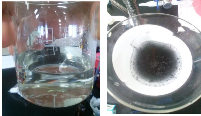
Figura 8.3 adsorción de Cromo (VI) con carbón pirólítico. Solución Final.
