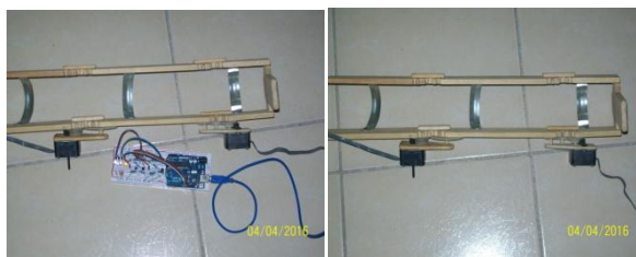
Figura V. Estructura con los motores montados y su circuito de control.
