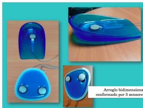
Fig. 4 Plantillas de gel baropodométricas construidas con un embebido de sensores MF01 en arreglo bidimensional.
