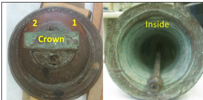
Figura 3. Áreas seleccionadas para la remoción de óxidos y ensayo electroquímico mediante EIS (ASA, interior y medio pie puntos 1 y 2)
