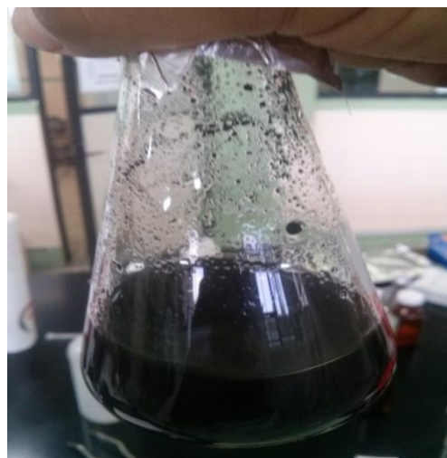
Figura 3.5 Soluciones de Cromo (VI) antes y después de agregar carbón pirolítico para su posterior titulación.
