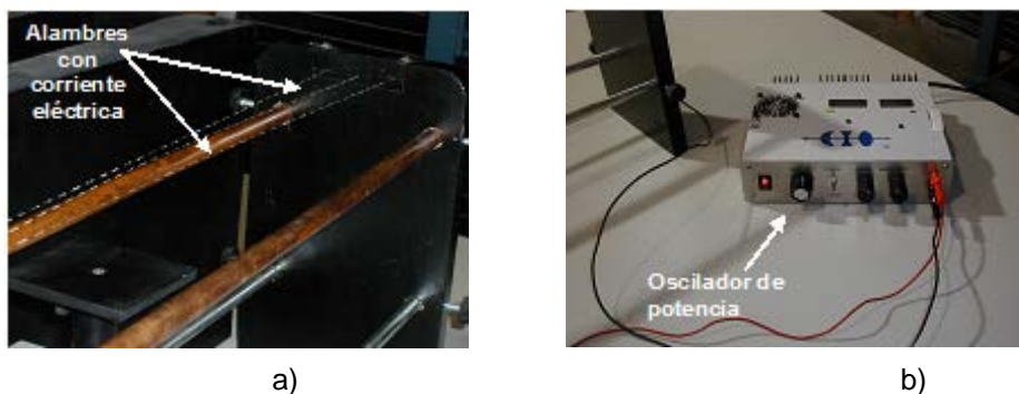
Figura 1. a) Alambres conductores, b) oscilador con amplificador de corriente
