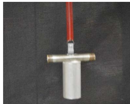
Figura 11. Arreglo para sujetar el péndulo de Wilberforce al cuerpo rígido
