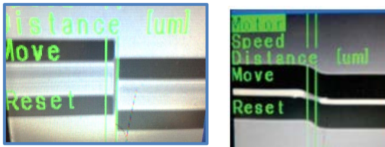
Figura 4. Empalme desalineado hasta 45 micras de dos fibras ópticas diferentes.
