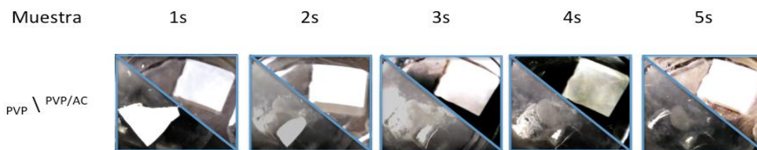
Figura 6. Comparativa entre membranas a base de PVP y las obtenidas en este trabajo con la adición de AC. Aún y cuando el tiempo de humectación es el mismo, la estabilidad de las que presentan AC es superior.
