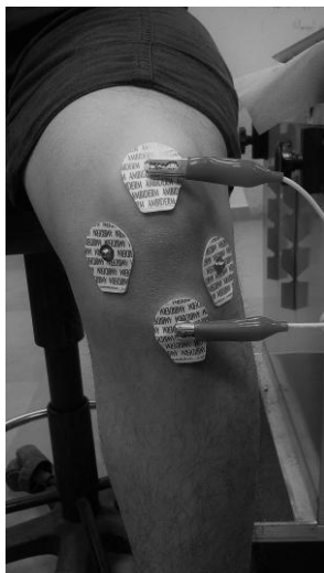
Figura 1. Arreglo de las 2 configuraciones de electrodos colocadas en cada voluntario para la adquisición de las variaciones de impedancia.
