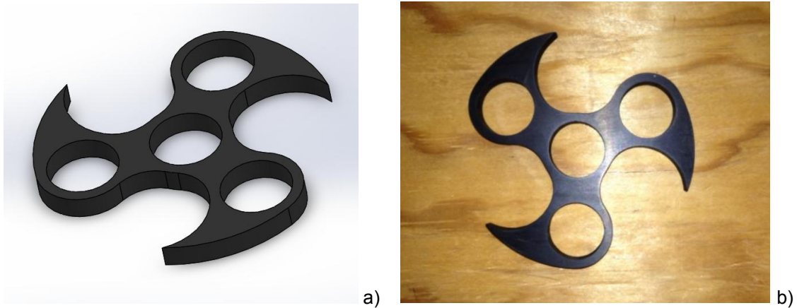
Figura 5. a) Diseño de spinner. b) Manufactura de spinner con impresión 3D.
