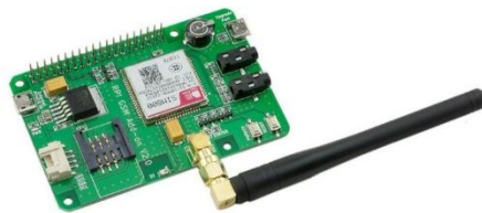
Ilustración 27: sistema de comunicación GSM
