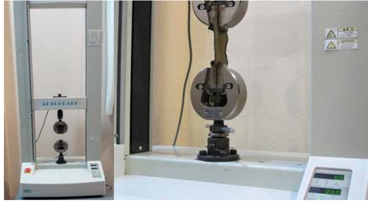
Fig. 7 a) Máquina universal Shimadzu AG – IS (Izquierda), b) ensayo a la tracción de la muestra de la tela Shantung sin hilo (derecha).
