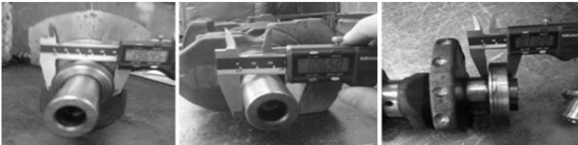
Figura 7. Toma de medidas del cigüeñal con calibrador Vernier digital
