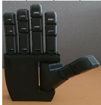
Figura 6. Prótesis de mano impresa en 3D
