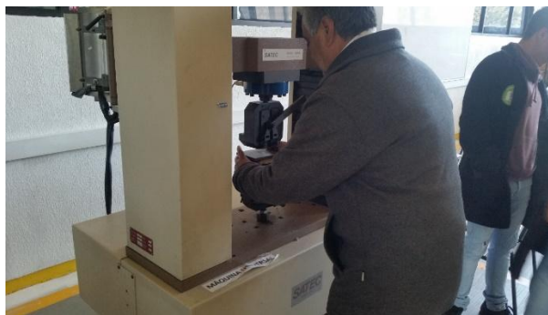
Figura no. 6. Prueba de compresión mediante maquina universal a la probeta a) de 67% cemento, con 33% pet.
