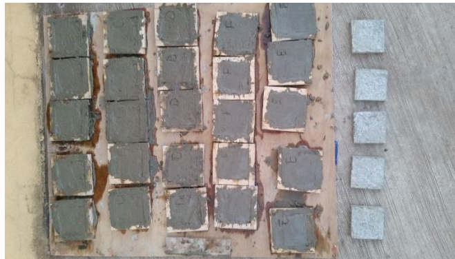
Figura no. 5. Elaboración y terminación de las probetas bajo las diferentes proporciones de los materiales pet y cemento.
