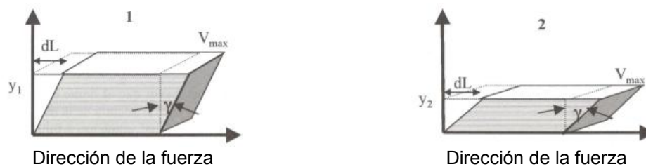
Fig. 1. Flujo de líquido entre dos planos paralelos para condiciones de baja velocidad de cizalla (1) y alta velocidad de cizalla (2).
