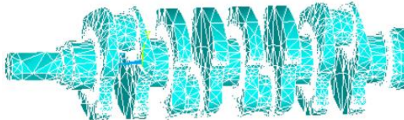
Figura 4. Modelo de elemento finito del cigüeñal de un motor a Diesel de 4 cilindros (Meng & Liu, 2011)
