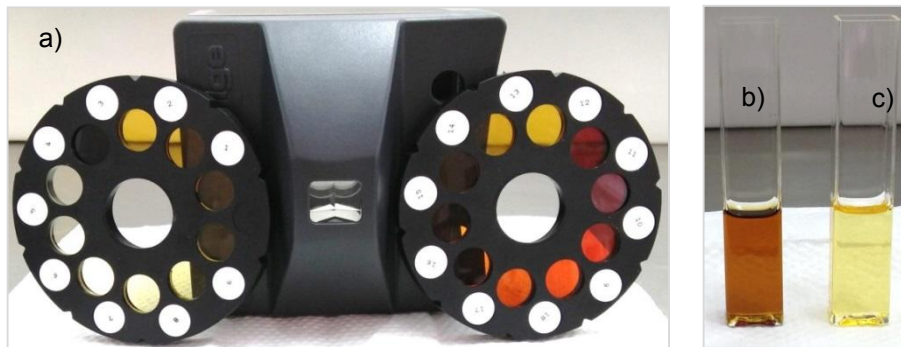
Figura 4. Determinación del color. a) colorímetro Gardner 705, b) muestra de surfactante, c) brea.
