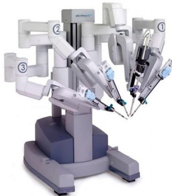
Figura 3. Robot de intervención quirúrgica [3].
