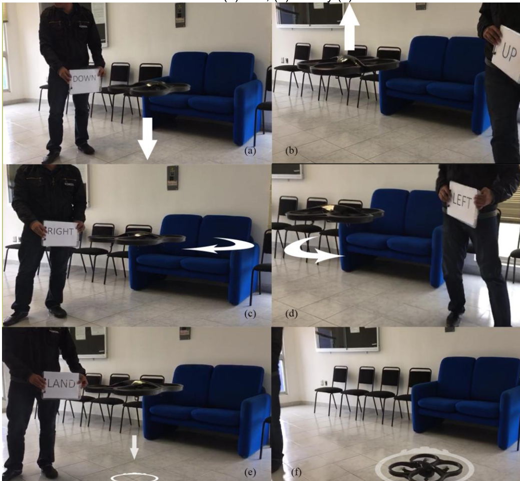
Figura 22. Control Servo Visual mediante el Reconocimiento Óptico de caracteres, etiquetas con comandos de control de navegación propuestos (a) Down, (b) Up, (c) Right, (d) Left, (e) Land y (f) Modo Land.
