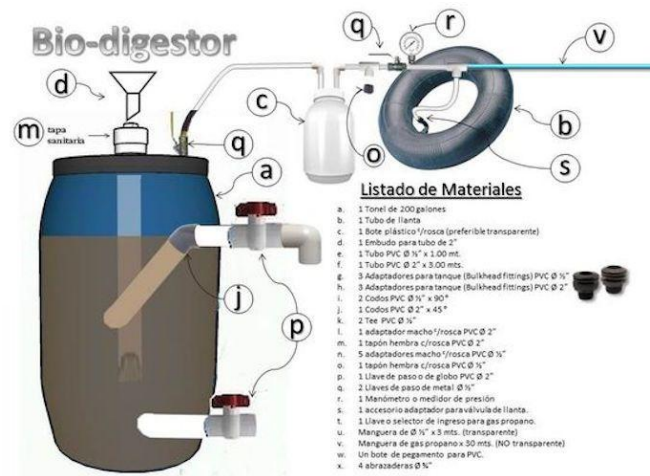
Fig. 2. Digestor anaeróbico casero [7]
