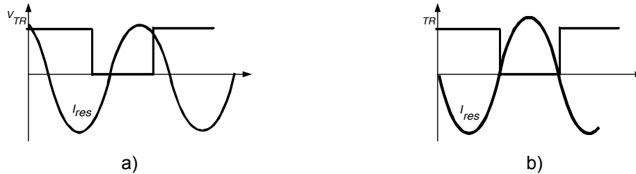
Fig.3 a) Conmutaciones en el tanque tipo inductivo b) Conmutaciones en resonancias
