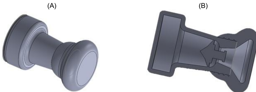
Figura 2. Diseño de la ducha ahorradora (2A) y sistema de la ducha ahorradora (2B)
