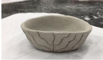
Figura 3. Pieza de prueba en estado de cuero preparada en la máquina de diseño.
