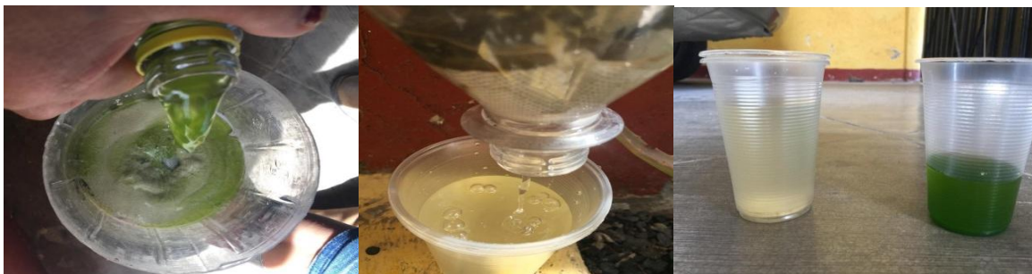
Figura 1. Medición de la funcionalidad del filtro propuesto. Fuente: elaboración propia.
