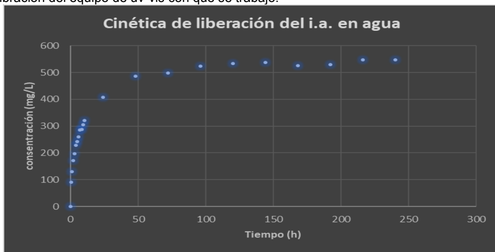
Figura 3. Cinética de liberación de un plaguicida por hidrogeles de AI-I partiendo de una concentración inicial de 0 mg/L.
