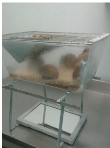
Fig 2. Dispositivo empleado para análisis de uso la cama, vista inferior.
