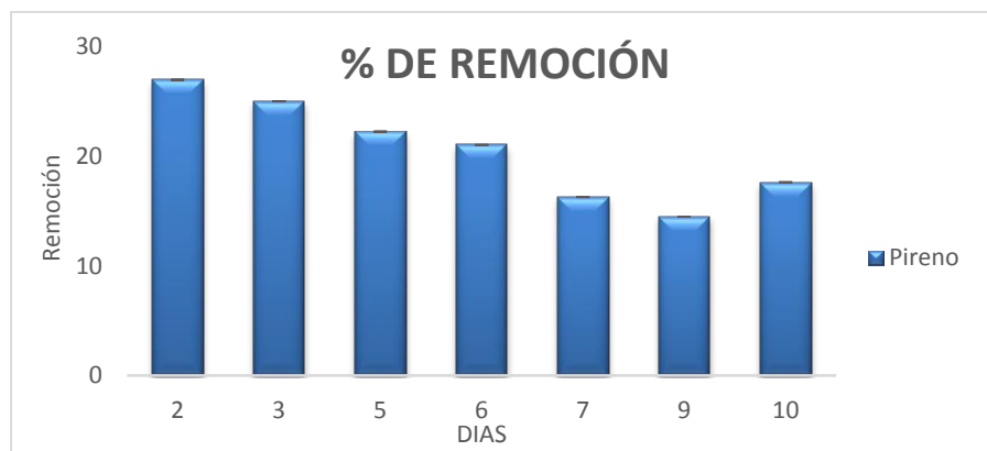
Gráfica 1. Porcentaje de remoción de pireno durante el proceso de biodegradación llevada a cabo por T. asperellum H15
