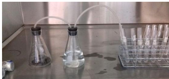
Fig. 2 Dispositivo de sulfhidración
