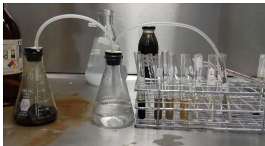
Fig.3 Sulfhidración de las muestras patrón.
