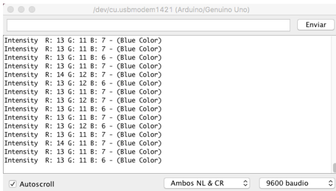
Figura 8. Monitor donde se muestran las intensidades capturadas por el TCS3200 para el color azul.
