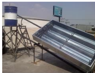
Fig.3. Calentador solar con lentes de Fresnel
